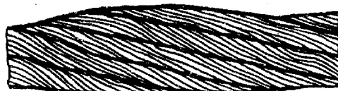
Рис. 12. Выдавливание проволок прядей: а — в одной пряди; б — в нескольких прядях
