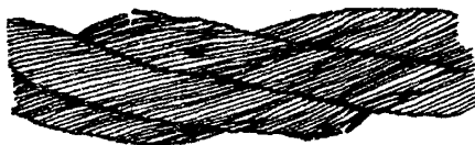
Рис. 1. Обрывы и смещения проволок каната крестовой свивки
