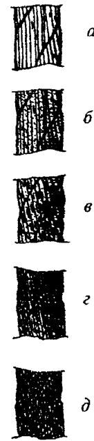
Рис. 6. Поверхностная коррозия проволок каната крестовой свивки: a — начальное окисление поверхности; б — общее окисление поверхности; в — заметное окисление; z — сильное окисление; д — интенсивная коррозия
